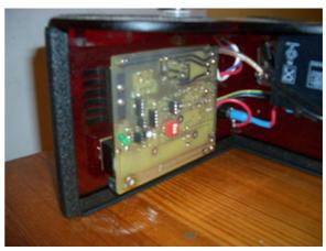
10. <u>Batterie aufladen:</u> Unterhalb der grünen Diode ist eine Öffnung nach außen gerichtet, in die das Ladekabel passt, an dem der Adapter hängt. Die Z-Machine kann auch während der Benutzung geladen werden, allerdings ist darauf aufzupassen, dass man sich nicht im Kabel verheddert. Ein voll geladener Akku reicht ca. für 300 Beschleunigungen, wobei die Ladezeit ca. 30-90 Minuten dauern kann, bis er wieder voll ist.
