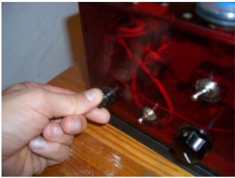
Das Eindrehen kann unter Umständen etwas schwer gehen, aber bitte ohne Gewalt eindrehen, lieber noch mal versuchen, da es eigentlich genau passt, wenn Drehrichtung und Druck stimmen. Eine Ersatzdiode ist auf dem nächsten Bild zu sehen und zwar unter der schwarzen Batterie.
